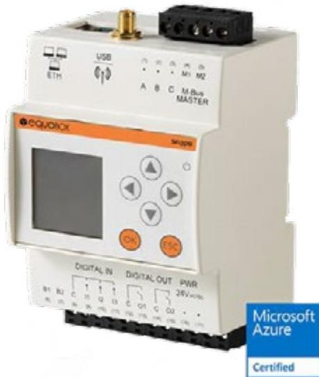
ENOLGAS Y0582 è un datalogger per l'acquisizione di dati provenienti dai RIPETITORI, che, attraverso la rete MESH, raccolgono informazioni da dispositivi che utilizzano il protocollo M-Bus cavo e wireless quali contatori, ripartitori di consumo e sonde. Gestisce fino a 3000 contatori (2500 wireless + 500 cavo) consentendo di memorizzare le letture quotidiane per 10 anni. L'interfaccia web permette la consultazione dei dati, la generazione dei report, il setup delle reti M-Bus e MESH.
